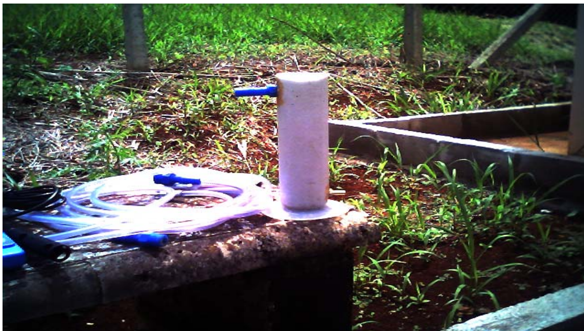
Celda de flujo con manguera.
