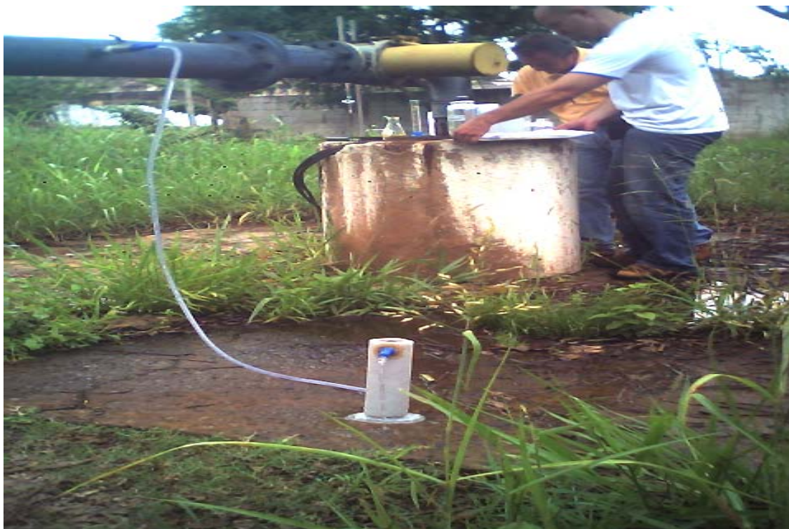
Funcionamiento de la cámara de flujo. Aquí se había terminado el muestreo y se estaba registrando en planilla de campo.
